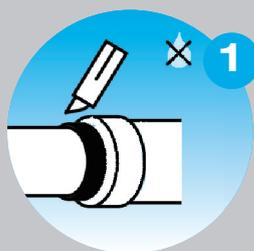
Couper et retirer votre joint défectueux sans démonter le wc. Vérifier que l'emplacement de la bague soit propre et sec.
