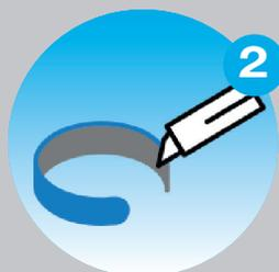
Couper la bague de réparation universelle au cutter.
