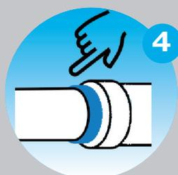
Repousser la bague à l'intérieur de la pipe WC. Vérifier qu'il n'y ait aucun trou entre la sortie WC et la pipe.
